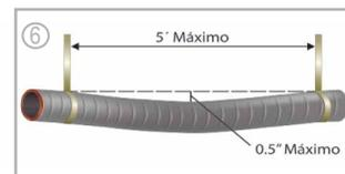
6.- El ducto flexible debe colgarse a un máximo de 5 pies (1.5 mts) entre soportes y con una pendiente máxima de 1/2 pulg. (12.5 mm) por pie lineal. La conexión a un conducto rígido se considerara como un soporte.
