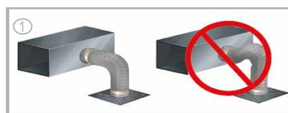
1.- Instale el ducto completamente extendido. No lo instale en su forma comprimida.
